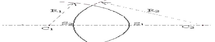
$C_1$  و  $C_2$  : مركزى الوجهين  $S_1$  و  $S_2$  : قاعدي الوجهين  $R_1$  و  $R_2$  : سمك العدسة  $S_1S_2$  : المسافة المار من نقطتين  $C_1$  و  $C_2$  يسمى المحور البصري للعدسة العدسة الرقيقة هي كل عدسة سماكتها صغير جداً مقارنة مع شعاعي وجوهها.
